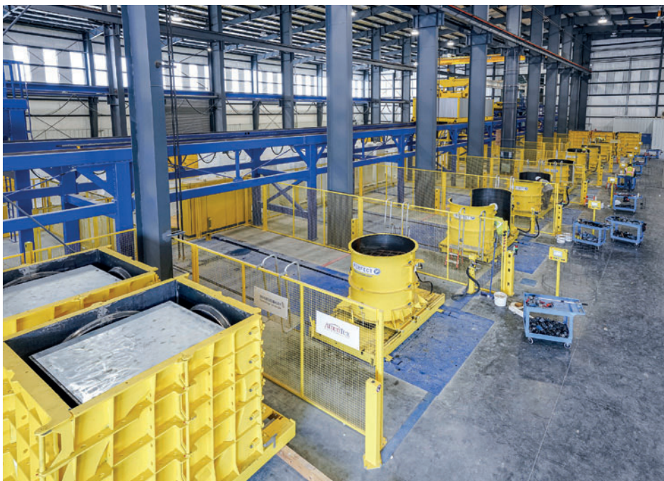
Семь станций оснащения вибротельных форм обеспечивают отсутствие задержек в работе всей системы, несмотря на различное время оснащения
