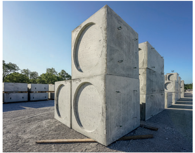
Помимо отдельных монолитных колец с дном Perfect, на линии также выпускаются прямоугольные и стандартные компоненты люков
